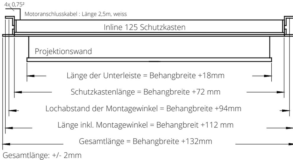
Alle Projektionswände im System Inline sind auch als Version für den Deckeneinbau lieferbar. Für den komfortablen Zugang zu den Befestigungsschrauben bei Montage und Service sind die beiden seitlichen Winkel steckbar. Montage und Demontage der Projektionswand ist ohne zusätzliche Deckenöffnung möglich!
