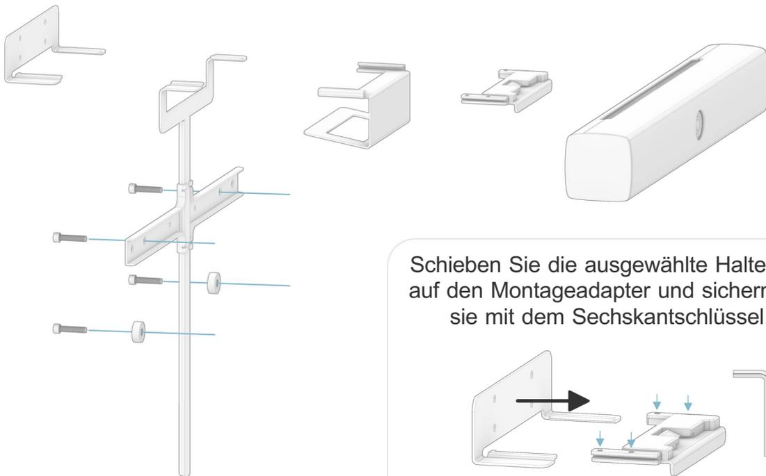
Schieben Sie die ausgewählte Halterung auf den Montageadapter und sichern Sie sie mit dem Sechskantschlüssel.
