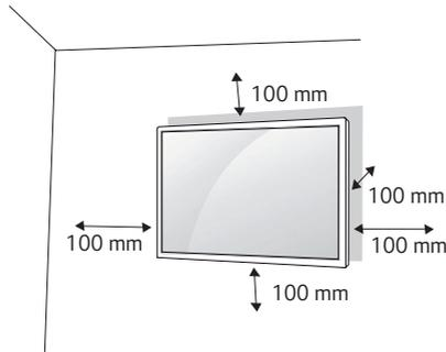
Um den Monitor an der Wand zu montieren, befestigen Sie die Wandhalterung (optionales Teil) an der Rückseite des Monitors.
